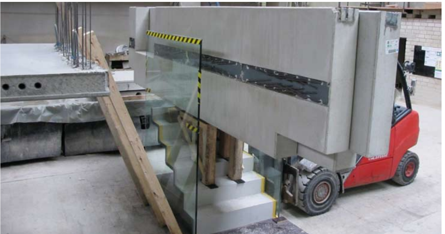
Belastungstest mit 7,4 Tonnen Gewicht
