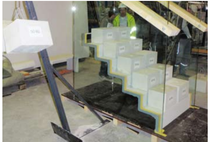
Erster Belastungstest mit je 100 kg
